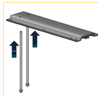
2 - Enfillez les tiges filetées sur la plaque de fixation
