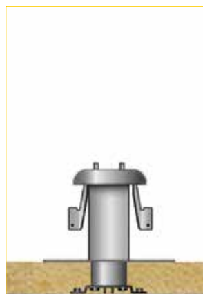
5 - Une fois votre isolant posé, placez le manchon d'étanchéité A , puis le support de plinthe B (si plinthe) et la collerette C . Vous pouvez effectuer votre relevé d'étanchéité.
