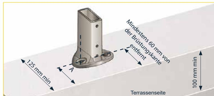
2 - Befolgen Sie die Empfehlungen, um die Grundplatte in einem Mindestabstand von der Brüstungskante zu befestigen.
